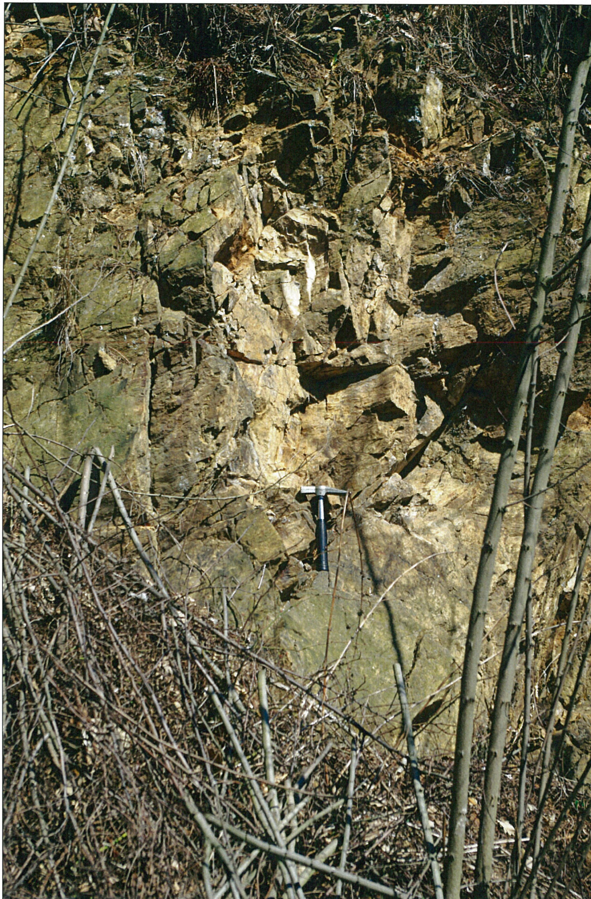
Foto – 19 Pohled na místo dokumentačního bodu DB 1 v km 1,550 vpravo v granitech a ortorulách.
