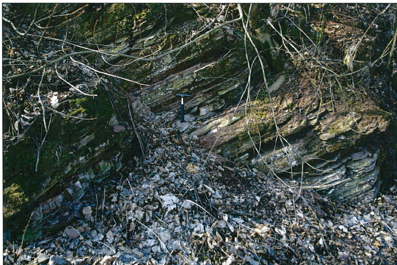
Foto – 14 Pohled na místo dokumentačního bodu DB 5 v km 9,080 vlevo. Střídají se pískovce s prachovci.
